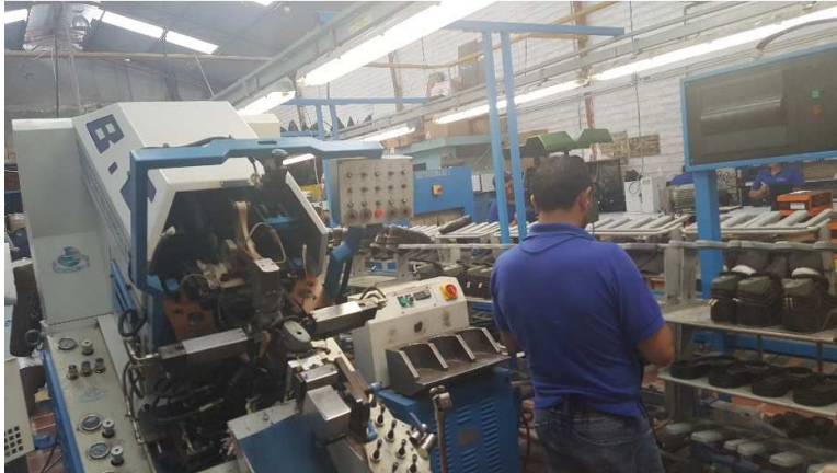
Figura 22. Montaje de suela 1
