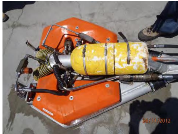
Ilustración 9. Equipo limpiador de cascos de embarcaciones.
