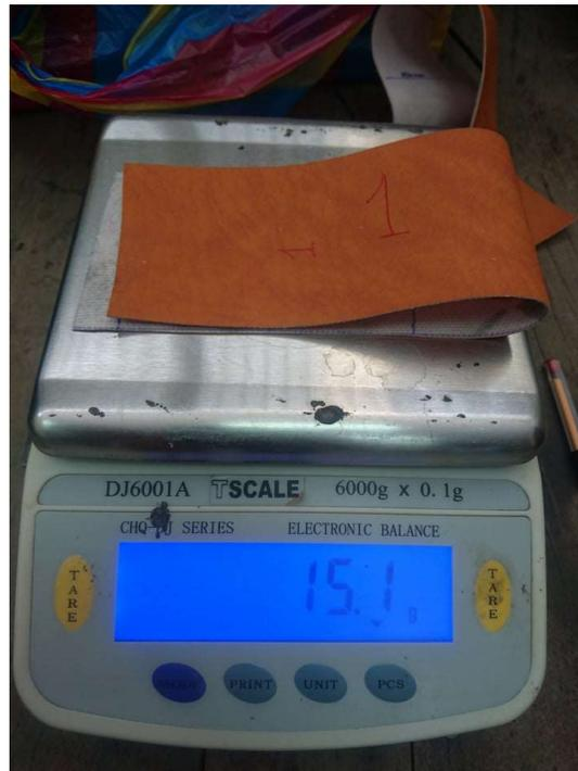
**OBSERVACIONES:** La probeta no pasa la prueba ya que su índice de inflamabilidad es superior a 250mm/min.
