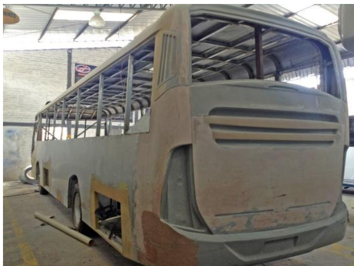
Figura 7 Preparación y Pintura
