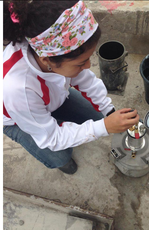
Elaboración de ensayo para la determinación de porcentajes de vacíos en el hormigón fresco
