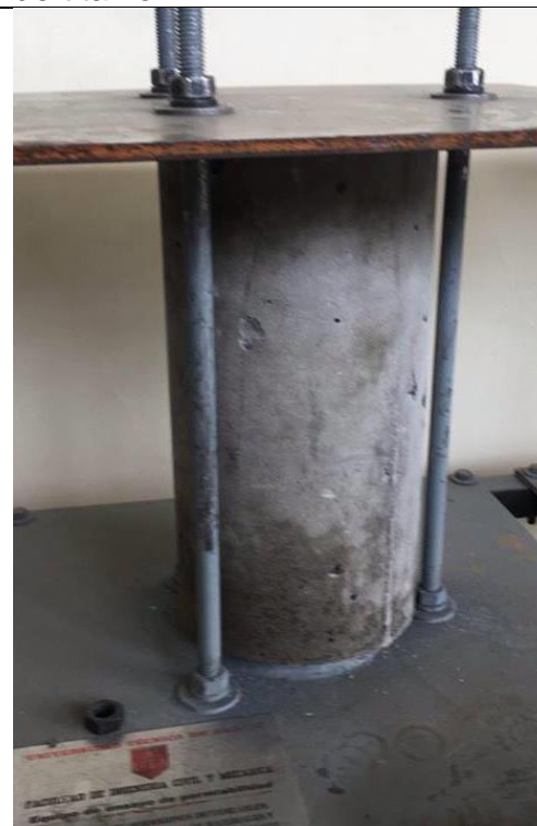
Realización de ensayo de permeabilidad para cilindros sin adición de TiO_2
