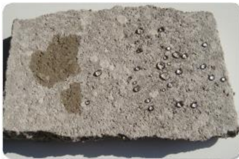
Fig. 2. (A) y (B) Comparación entre una superficie hidrófuga y una normal
