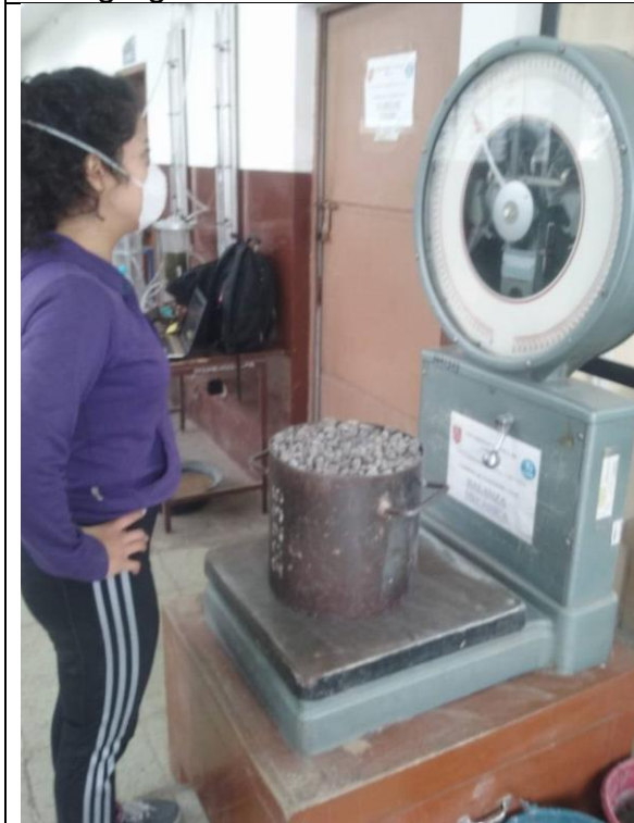
Determinación de la densidad aparente de la mezcla
