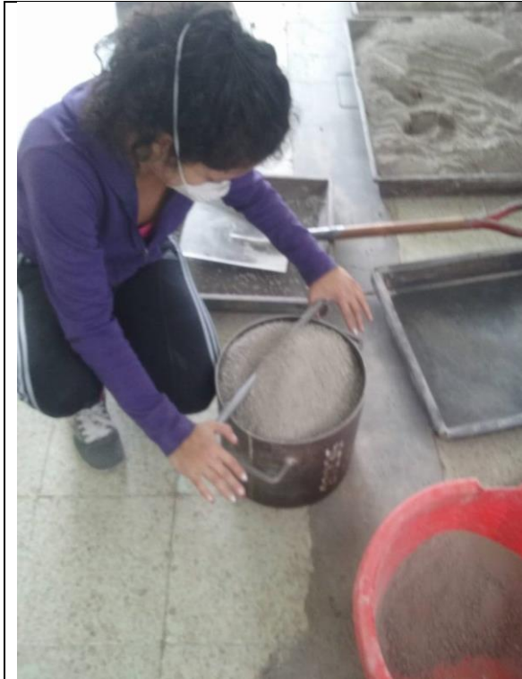
Determinación de la densidad aparente del agregado fino
