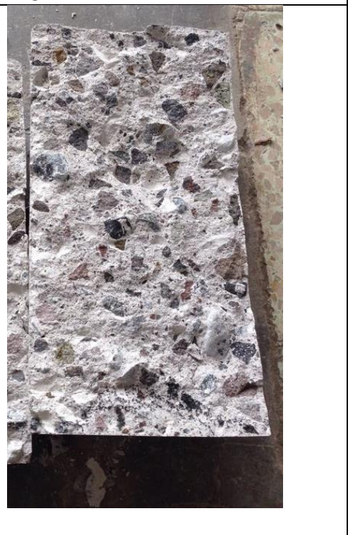
Observación de penetración de agua para cilindros con el 15% de \text{TiO}_2
