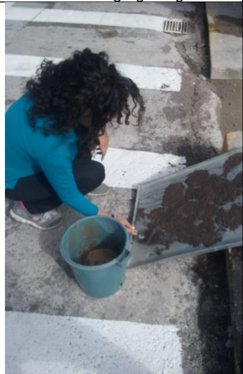
Colocación de la arena al sol para obtener la superficie en estado SSS
