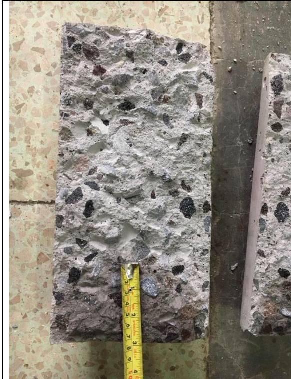
Observación de penetración de agua para cilindros sin adición de \text{TiO}_2
