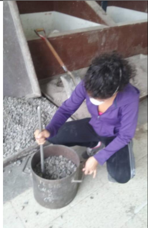
Determinación de la densidad aparente del agregado grueso
