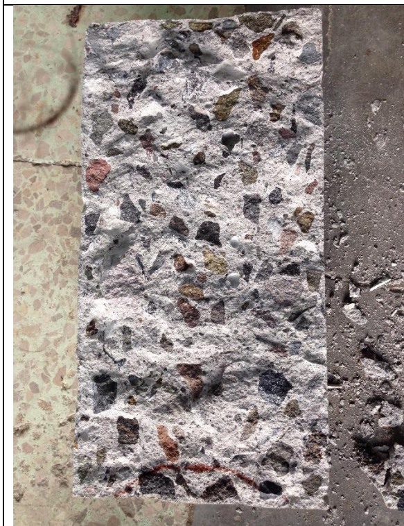
Observación de penetración de agua para cilindros con el 10% de \text{TiO}_2
