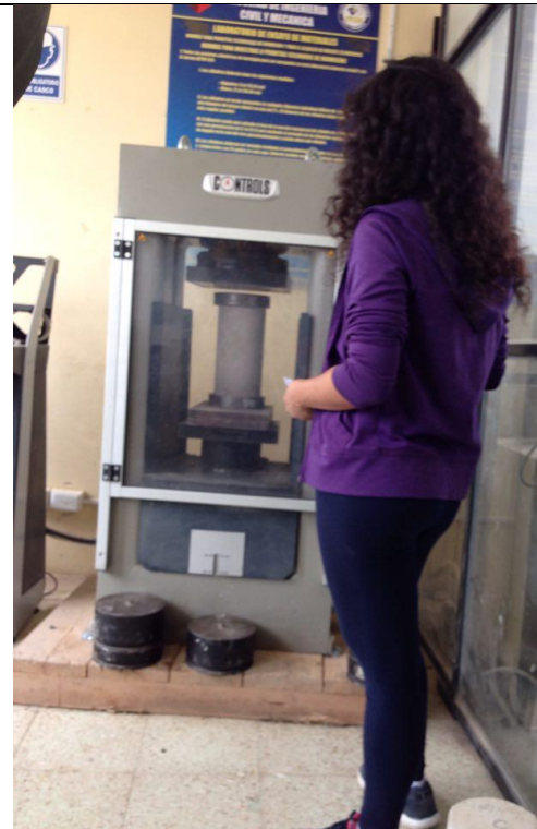
Elaboración de ensayo a compresión
