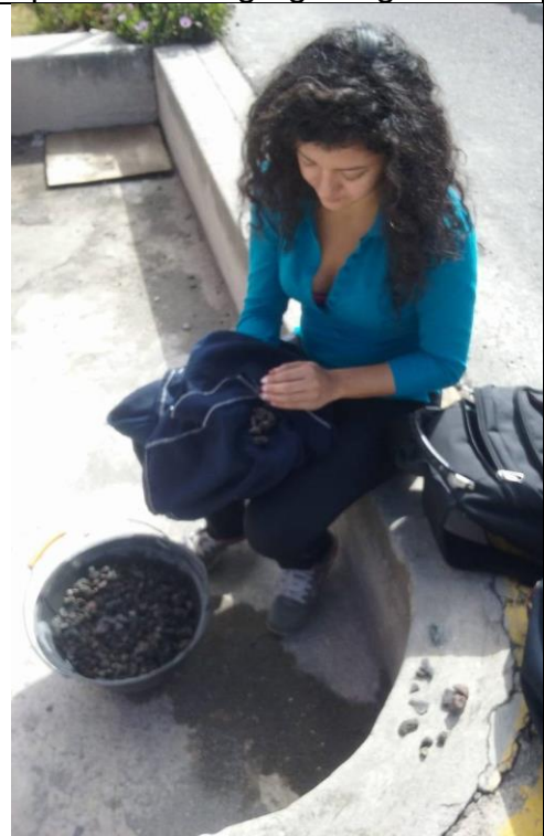
Secado del agregado grueso para obtener la superficie en estado SSS
