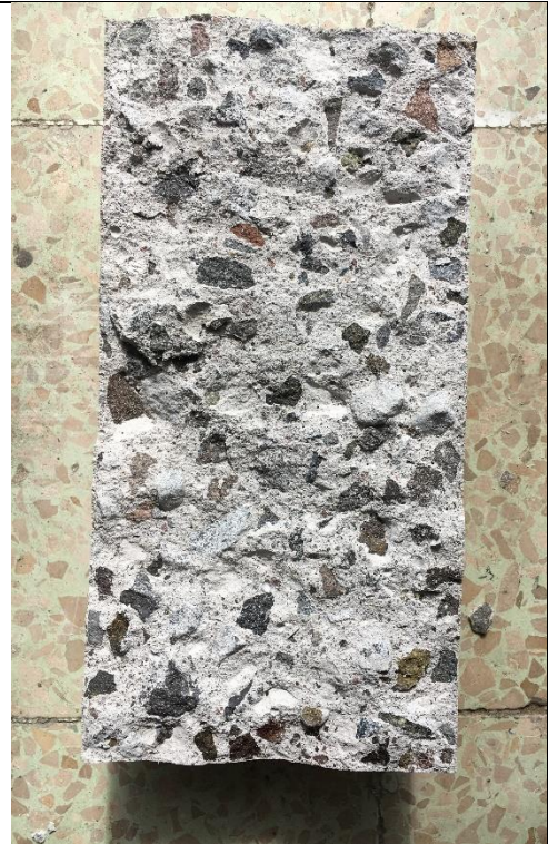
Observación de penetración de agua para cilindros con el 5% de \text{TiO}_2
