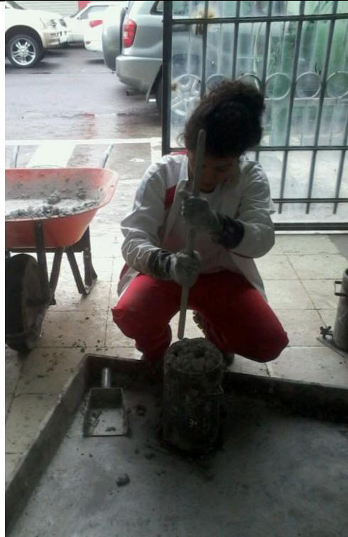
Elaboración de cilindros de hormigón con el 10% de \text{TiO}_2
