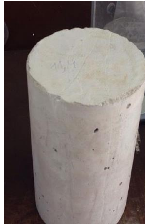
Observación de porosidades de cilindros con adición de dióxido de titanio
