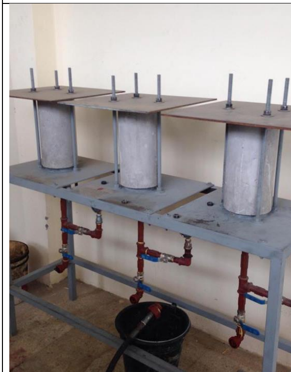
Elaboración de ensayo de permeabilidad de los cilindros
