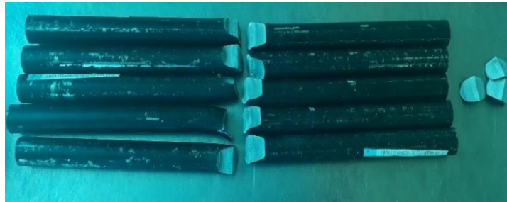
Gráfica 3-15 Probetas ensayadas con el ensayo guiado de flexión en tres puntos.
