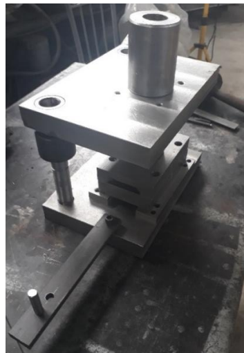
Gráfica 3-69. Ensamble del troquel de corte y perforado.
