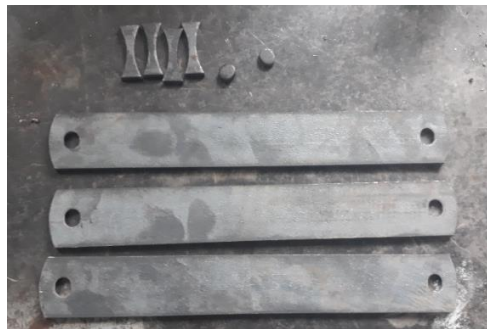
Gráfica 3-70. Piezas obtenidas mediante el troquel de corte y perforado.
