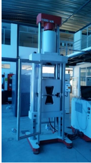
Gráfica 3-7. Máquina de Ensayos Universal Metro Test 1500 KN para el ensayo de tracción.
