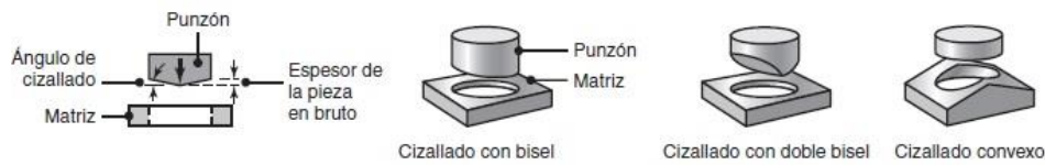
Gráfica 3-21. Geometrías representativas para el proceso de cizallado [10].
