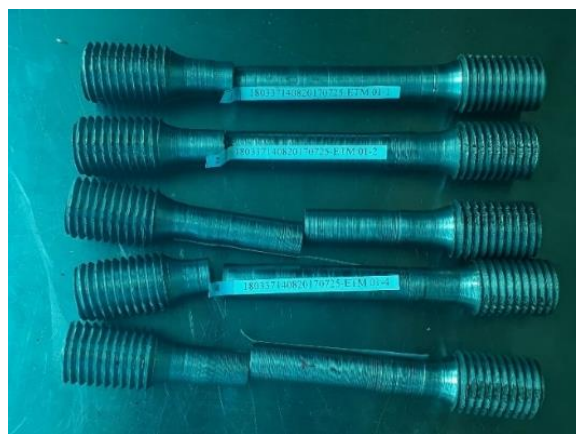
Gráfica 3-9. Probetas Cilíndricas ensayadas acero AISI-SAE D3.
