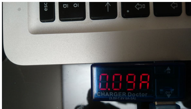
Figura 4.30. Consumo de Corriente del prototipo en funcionamiento.
