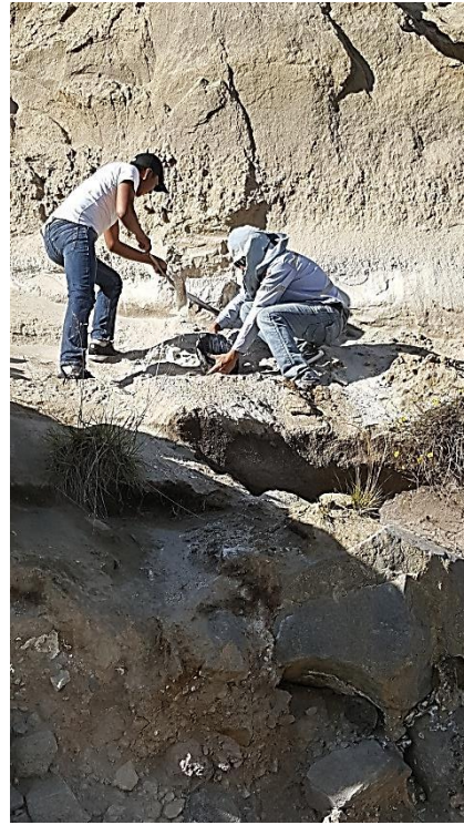
Fotografía N°7. Toma de muestra 2 para propiedades de suelo
