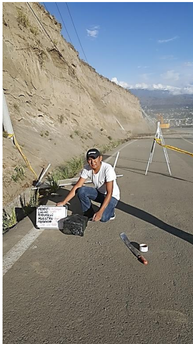
Fotografía N° 10. Bloque #3 para ensayo triaxial
