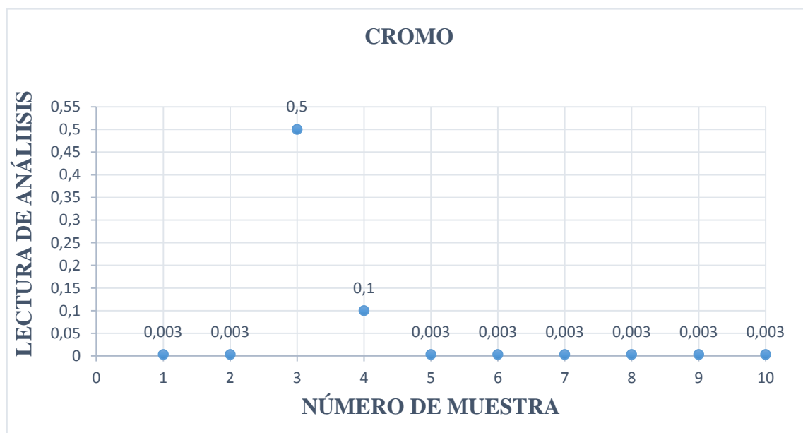
Gráfico 1. Comportamiento de cromo en el agua residual industrial durante el proceso de filtración
