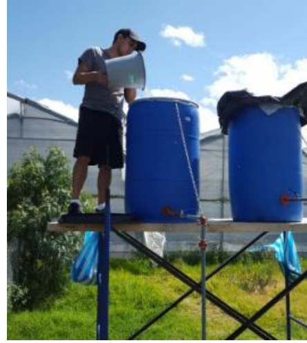
8. Colocación de agua residual en tanque
