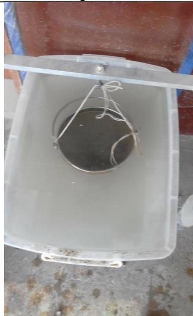
Pesando la canastilla con material sumergida en agua.
