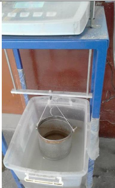
Pesando la canastilla vacía sumergida en el agua
