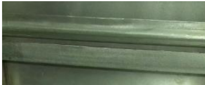
Figura 60.- Ángulo acero inoxidable 25*25*3 mm.
