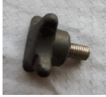
Figura 98.- Manilla-pasador-tuerca ensamble final.
