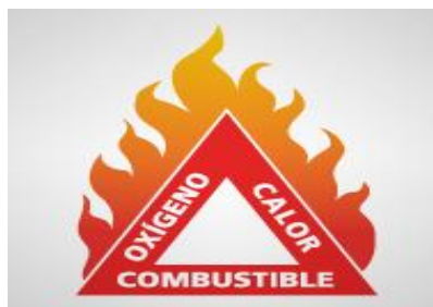
Figura 1. -Elementos necesarios para la combustión.
