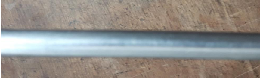
Figura 55.- Varilla lisa de 10 mm de diámetro.
