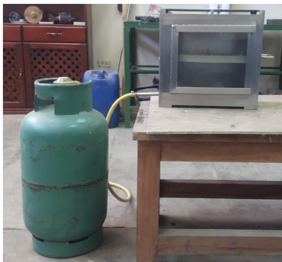
Figura 105. -Banco de pruebas con instalación de suministro de GLP finalizado.
