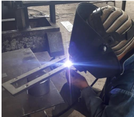
Figura 75. -Proceso de soldado de pernos en la base del portamuestras.
