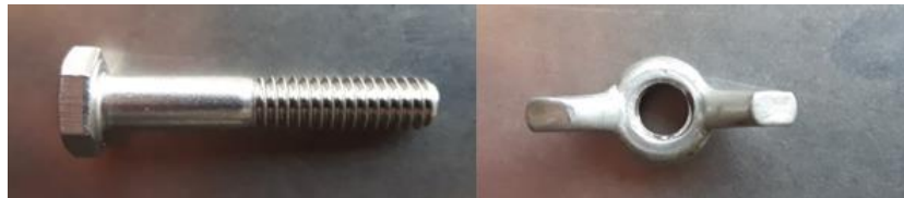
Figura 56.- Pernos y tuercas de ¼ de pulgada.
