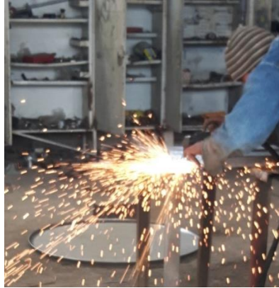
Figura 73. -Proceso de oxicorte para formado de piezas.
