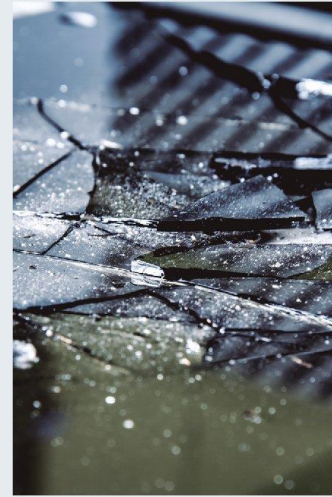
Vidrio sin templar o mal templado
