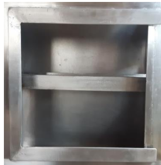
Figura 99.- Marco ventana de acceso ensamble final.
