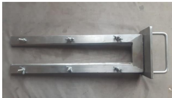
Figura 95.- Portamuestras ensamble final.
