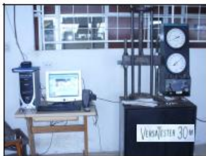
FIGURA 2.7 EQUIPO COMPLETO VERSATESTER 30M ADAPTADO A COMPUTADORA PARA ENSAYO DE PROBETAS EN BASE DE Sn
