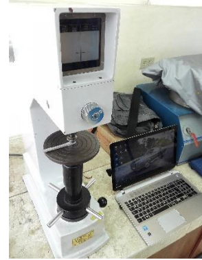
Figura 29 Realización de ensayos de Dureza Brinell HB en los laboratorios de la Carrera de Ingeniería Mecánica FICM-UTA.
