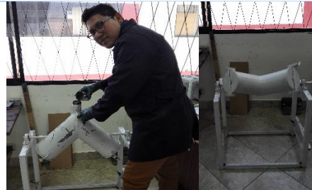
Figura 24 Ingreso de material y recipiente de mezclado.
