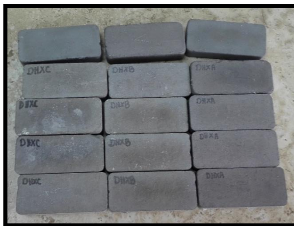
Figura 34 Probetas de desgaste realizadas bajo las Norma ASTM G 105 (Fuente: Autor)
