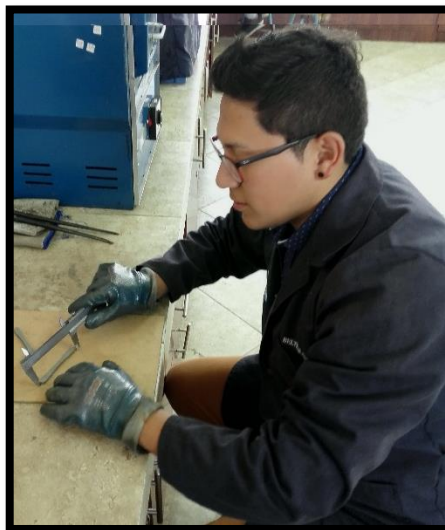
Figura 38 Control de dimensiones de probetas para ensayo a Tracción bajo norma ASTM E 8 M. (Fuente: Autor)
