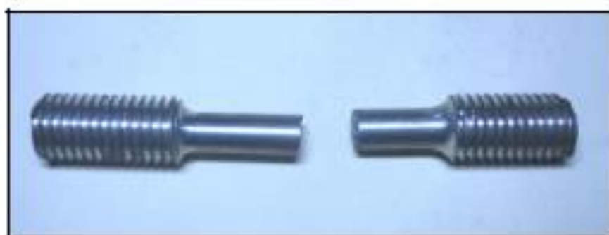
FIGURA 2.8 FRACTURA FRÁGIL DE PROBETA DE BABBITT EN BASE DE Sn
