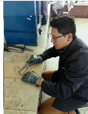
Figura 28 Proceso realizado por inspección con calibrador pie de rey para control de dimensiones.
