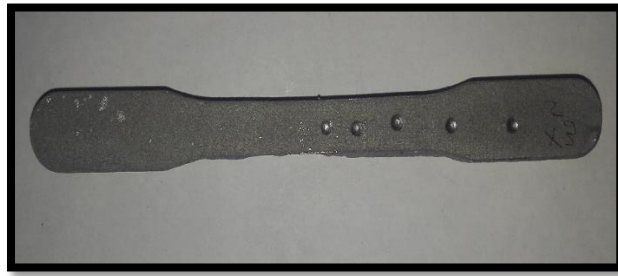
Figura 31 Penetraciones de bola en el material obtenido en el proceso de pulvimetalurgia. (Fuente: Autor)
