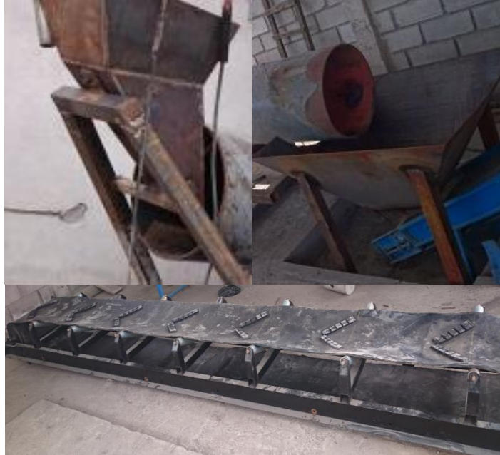
Figura 3. 47. Tolvas de entrada, salida y banda transportadora.
