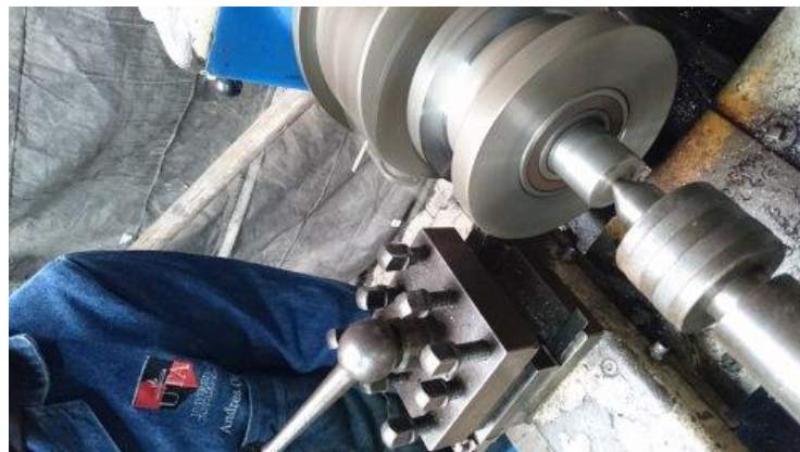
Figura 3. 42. Maquinado de rodillos de soporte.
