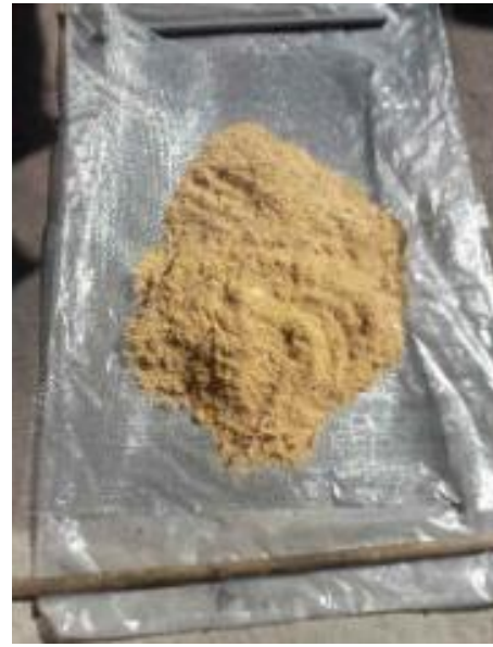
Material filtrante aserrín
