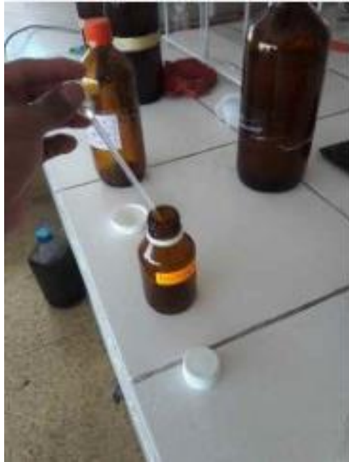
Colocar ácido sulfúrico ( \text{H}_2\text{SO}_4 )
