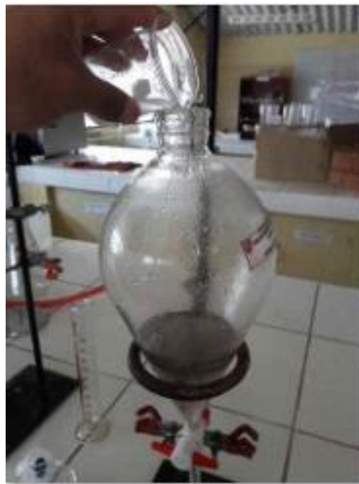
Colocación de Hexano en el embudo
