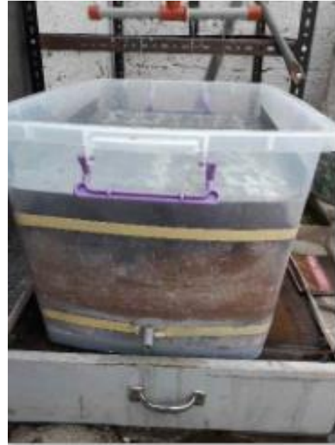
Descarga del agua filtrada
