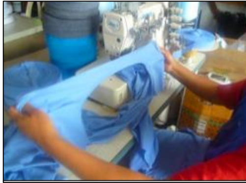
Figura 23 Unión Collarete Hombro Faltante
