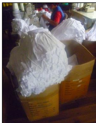
Figura 58 Acumulación Inventario en Proceso
