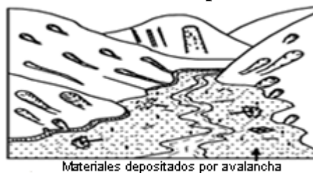
Figura N°. 10: Avalancha por deslizamiento
