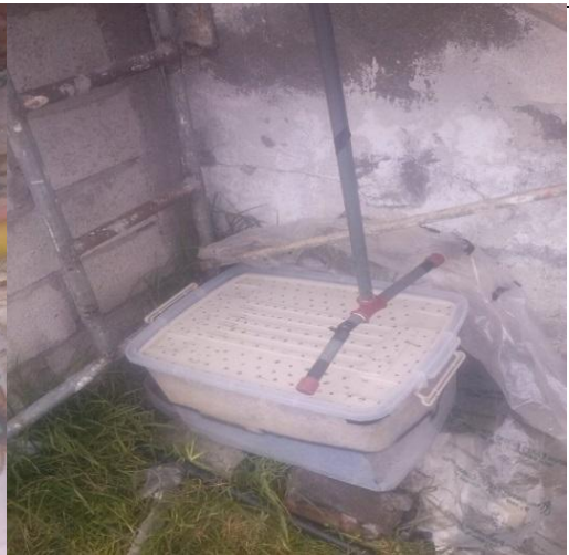
Evacuación del caudal sobre el lecho filtrante.
