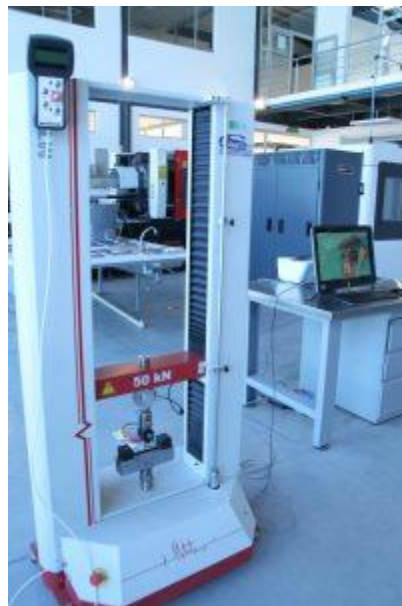
Figura 3-22 Máquina Universal de Ensayos Electromecánicos Metrotec MTE50.
