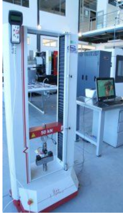
Figura 2-7 Máquina Universal de Ensayos Electromecánicos Metrotec MTE50.
