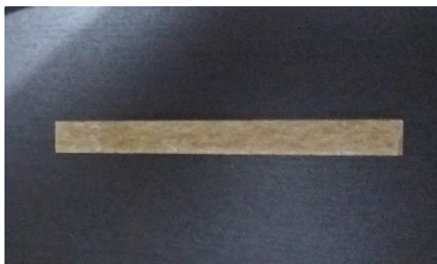
Figura 3-20 Probetas para ensayo a flexión según normas ASTM 7264-07
