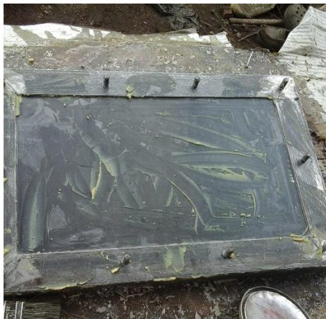
Figura 3-11 Aplicación de cera
