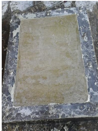
Figura 3-17 Desmolde del material compuesto.
