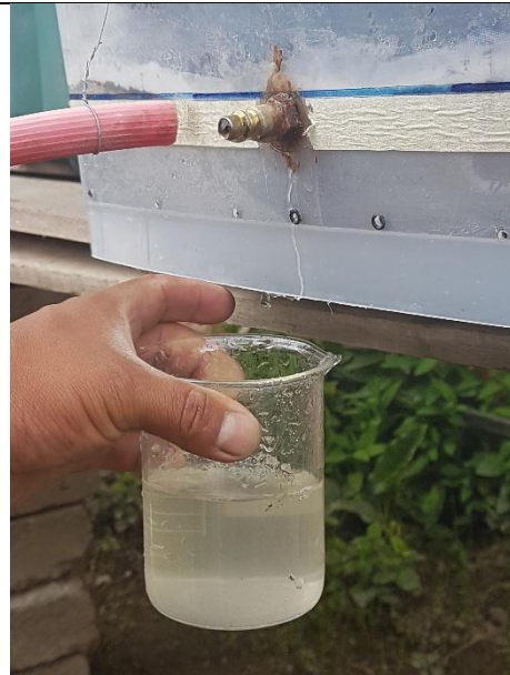
FIGURA 43. Agua después del Proceso de Filtración
