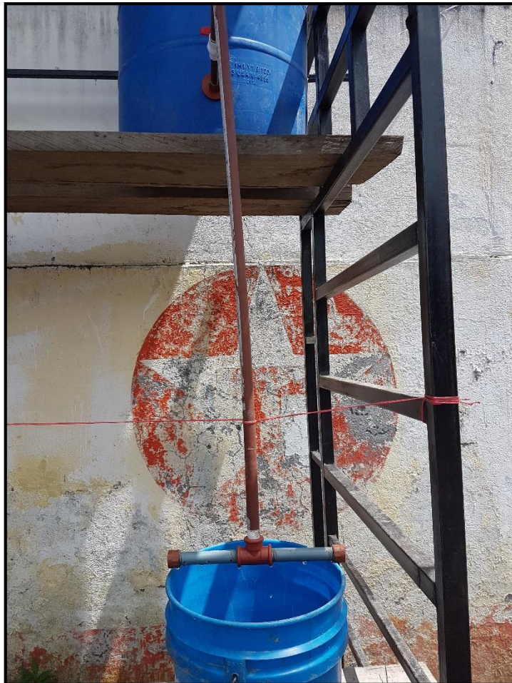
FIGURA 8. Depósito y Tuberías de Circulación con Aspersor
