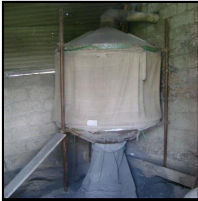
Imagen 9. Tolva recolectora Fuente: Autor
