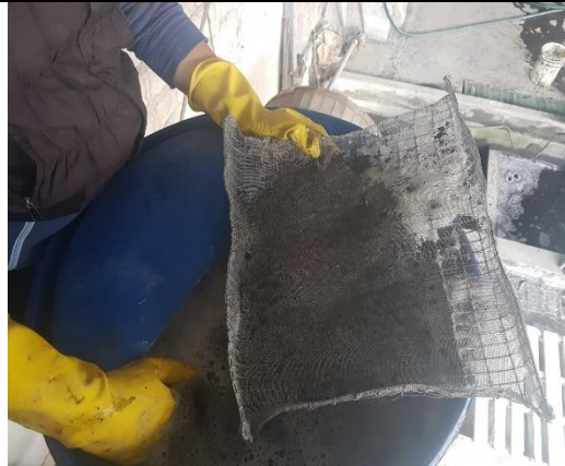
Imagen 30. Agua residual en el tanque pasado por tamiz
