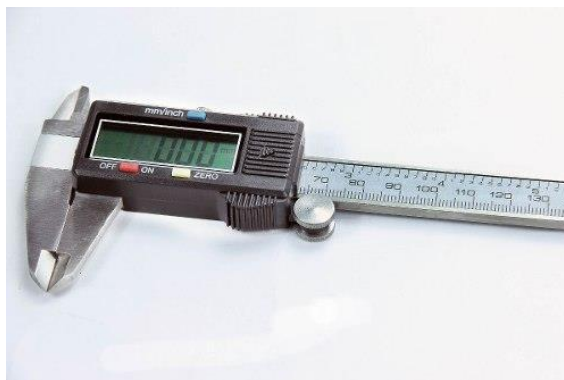
Figura 3. 17 Calibrador pie de rey digital Fuente: Autor
