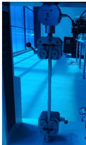
Figura 3. 26 Probetas sujetadas los extremos para el análisis de tracción Fuente: Autor
