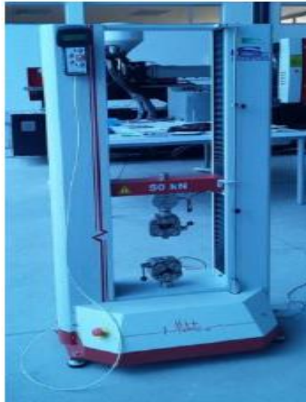
Figura 3. 23 Máquina universal METROTEC MTE - 50 Fuente: Autor
