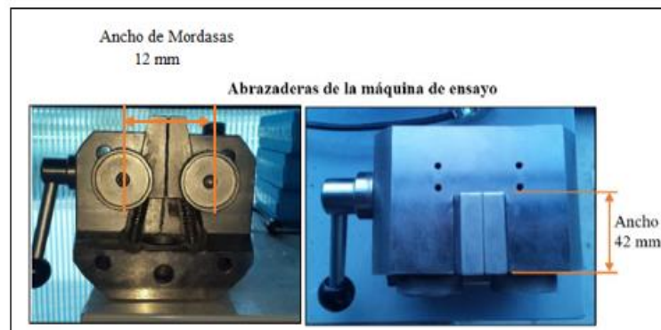
Figura 3. 24 Abrazaderas de la máquina universal METROTEC MTE - 50 Fuente: Autor
