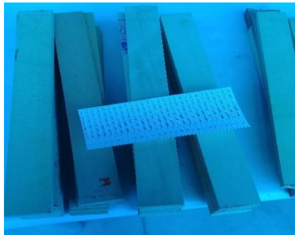
Figura 3. 12 Probetas para análisis de flexión Fuente: Autor
