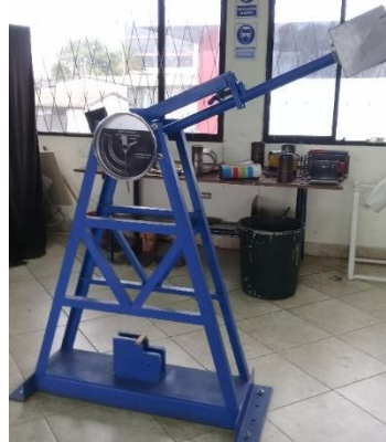
Figura 3. 27 Máquina de péndulo Charpy Fuente: Autor
