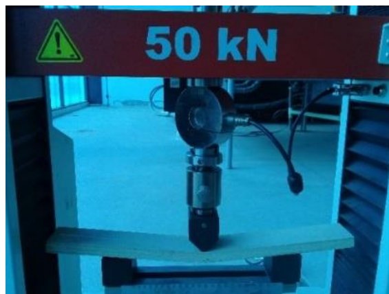
Figura 3. 19 Aplicación de fuerza sobre la probeta Fuente: Autor
