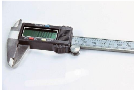
Figura 3. 29 Calibrador pie de rey digital Fuente: Autor
