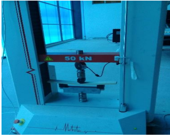
Figura 3. 15 Máquina universal METROTEC MTE - 50 Fuente: Autor
