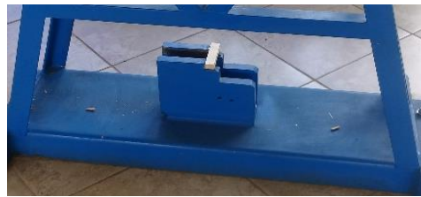
Figura 3. 30 Colocación de la probeta en el puente de ensayo Fuente: Autor
