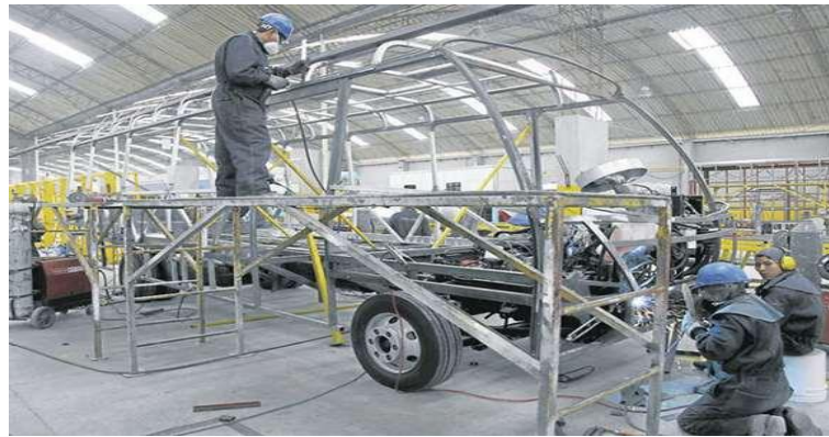
Figura 3. 2 Construcción Estructura. Fuente: [28].
