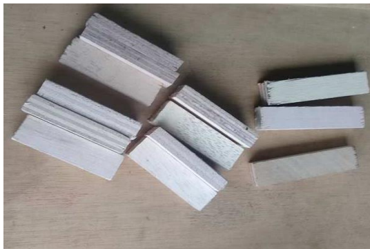
Figura 3. 14 Probetas para análisis de impacto Fuente: Autor
