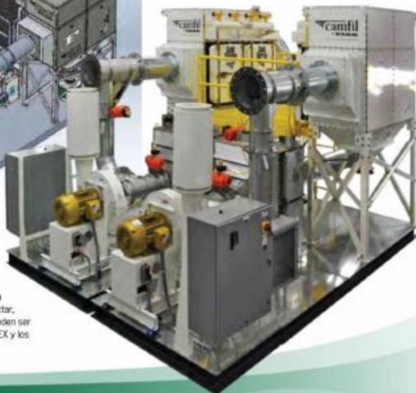
Sistema de extracción de polvo pre-ensamblado montado sobre plataforma
