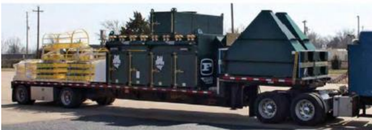
Sistema de extracción de polvo pre-ensamblado montado sobre plataforma
