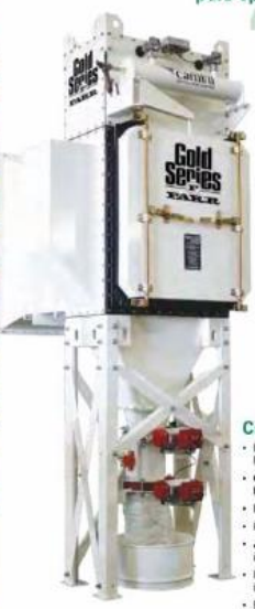
Entrada en la parte superior. Un flujo cruzado es creado a través de los filtros. Elimina las corrientes secundarias asociadas a los filtros tradicionales.
