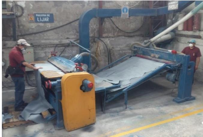
Figura 17. Proceso de Lijado
