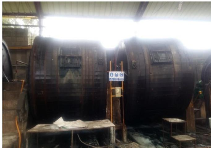
Figura 6. Bombos del Área de Pelambre
