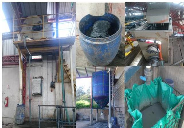
Figura 67. Máquina separadora de solidos
