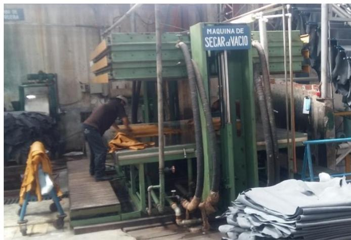
Figura 14. Proceso de Secado al Vacío
