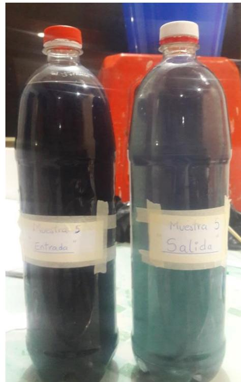
**Ilustración 30: Muestra de afluente y efluente.**
