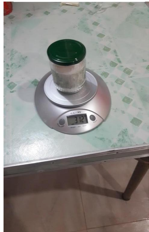
**Ilustración 17: Dosificación del sulfato de aluminio para el Prototipo.**
