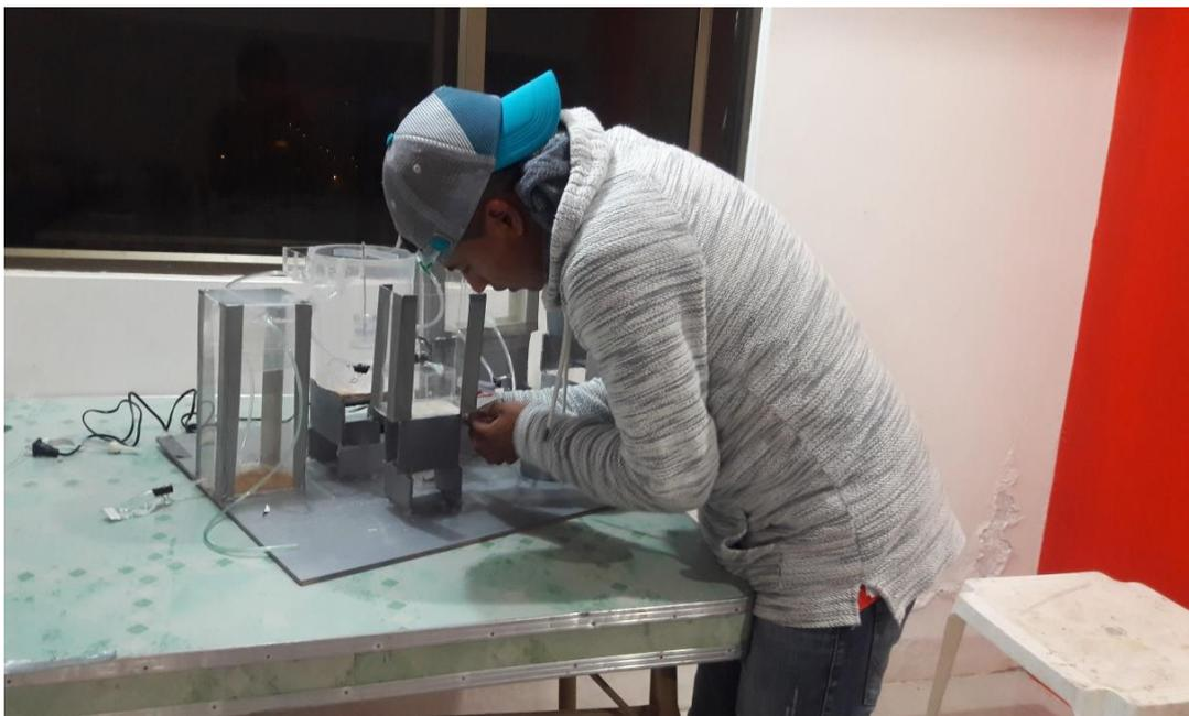
**Ilustración 9: Visualización del tratamiento preliminar (Rejilla, desarenador y canal parshall).**
