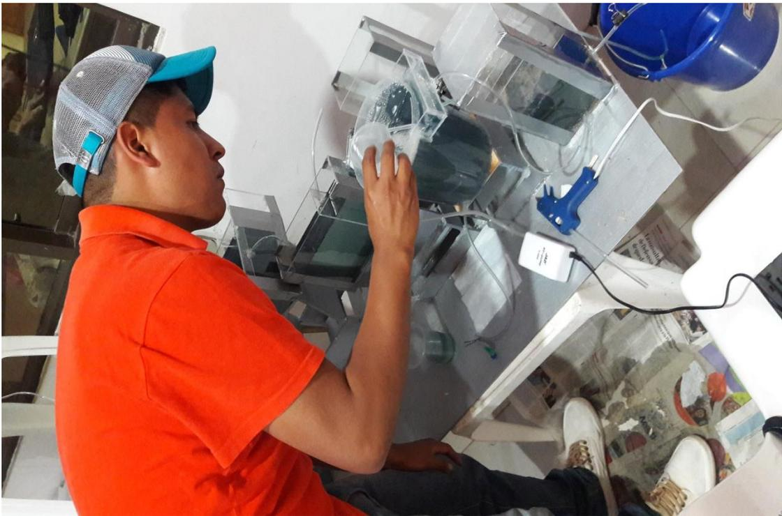
**Ilustración 23: LLenado del UASB**
