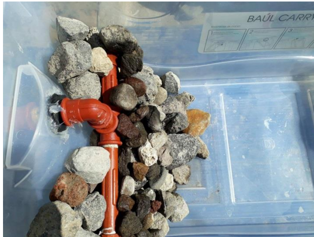
Foto N°4.- Colocación de las piedras al inicio y final del prototipo
