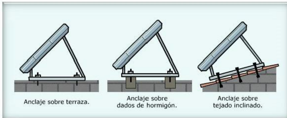
Gráfico 37: Diferentes tipos de estructura soporte para paneles solares [20]
