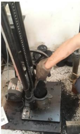
Colocación de la mezcla en el molde.
