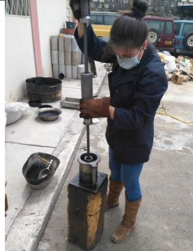
Compactación de la briqueta.
