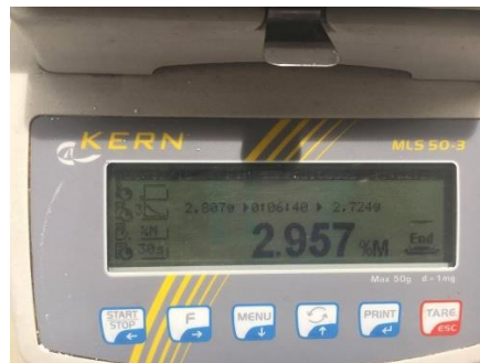
Imagen 7. Medición de humedad del agua de coco en polvo
