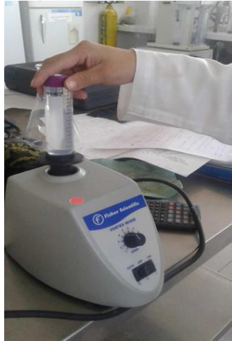
Imagen 5. Homogenización de la muestra para determinación de solubilidad
