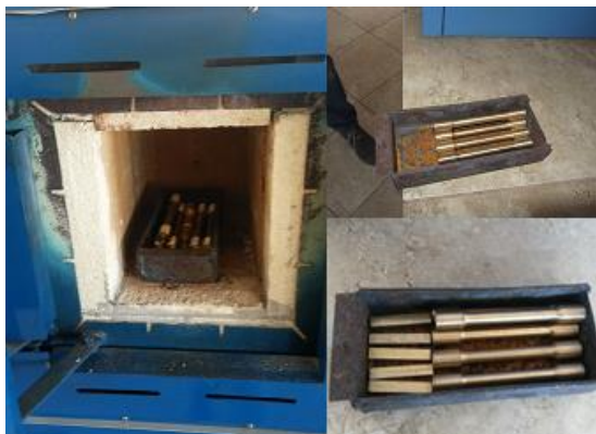
Figura 51. Horno y probetas para tratamiento térmico (Fuente: La Autora).
