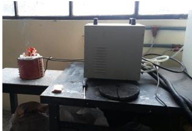
Figura 21. Fundición en un horno a inducción en la UTA, prueba 4 (Fuente: La Autora).
