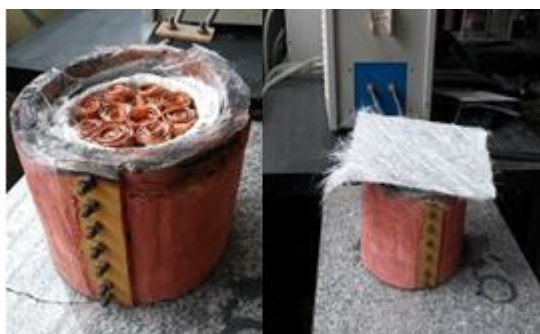
Figura 45. Carga del crisol con cobre en el horno a inducción (Fuente: La Autora)
