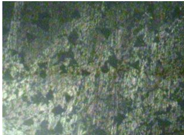
Aleación 66.94 %Cu y 32.70 % Zn , Templada, 100X, Cobre y sus aleaciones, 5 seg.
