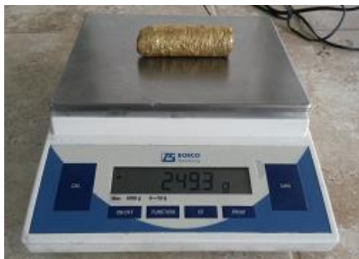
Figura 62. Determinación de la masa de la aleación inteligente con memoria de forma (Fuente: La Autora).
