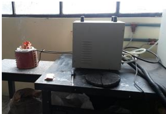
Figura 22. Fundición en un horno a inducción en la UTA, prueba 5 (Fuente: La Autora)
