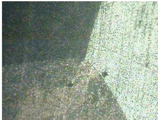
Aleación 53.25 % Cu y 46.38% Zn , Sin templar, 100X, Cobre y sus aleaciones, 120 seg.
