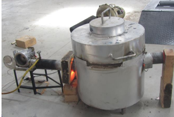
Figura 18. Fundición en un horno a gas en la ESPOCH, prueba 1 (Fuente: La Autora).
