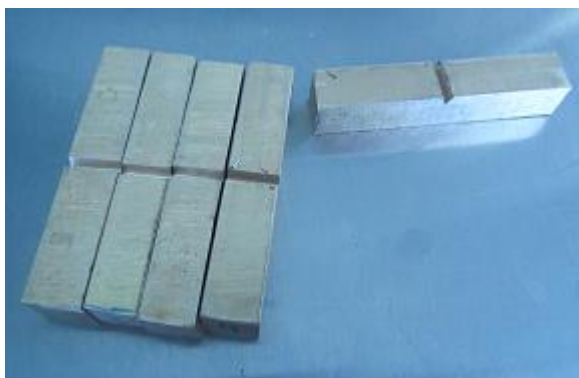
Figura 49. Probetas maquinadas para el ensayo Charpy tipo A, (Fuente: La Autora).
