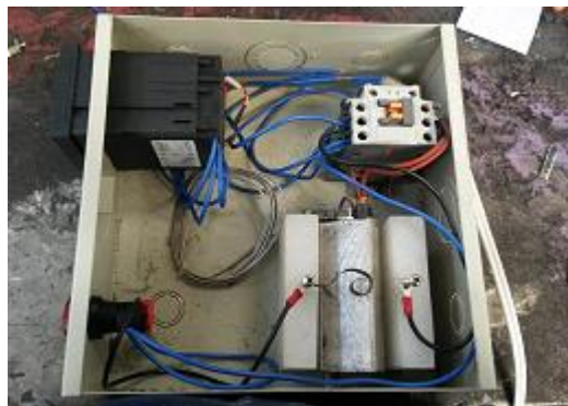
Figura 67. Componentes del circuito para comprobación de la memoria de forma de la aleación 59.32% Cu - 40.08% Zn (Fuente: La Autora).
