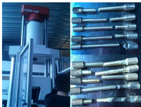
Figura 59. Ensayo de tracción, máquina universal y probetas ensayadas (Fuente: La Autora).
