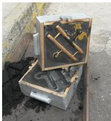
Figura 46. Probetas obtenidas después de colar la aleación en el molde (Fuente: La Autora).
