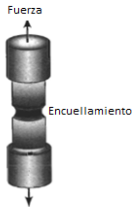
Figura 13. Deformación localizada durante el ensayo de tracción de un material dúctil produciendo una región de encuellamiento (Fuente: Askeland, 2011).
