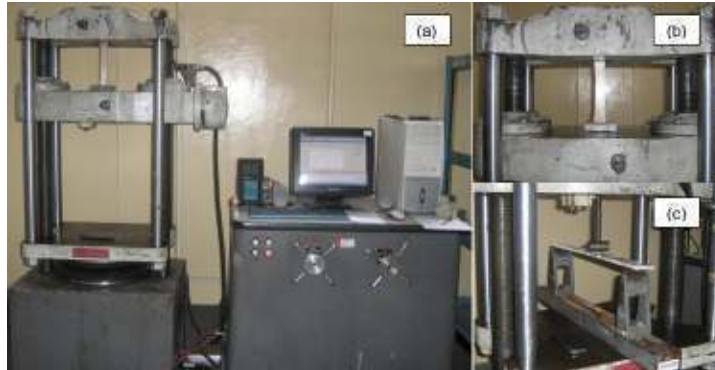
Figura 32: (a) Máquina universal de ensayos Tinius Olsen modelo Súper L. (b) Mordazas Cuneiformes. (c) Set de flexión a tres puntos [13].
