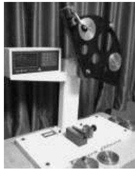
Figura 36: Máquina de ensayo Charpy Tinius Olsen IT 504 [13].
