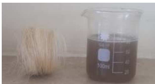
Figura 53: Resina de Moldeo sin MEK (80 ml de RP y 0,12 ml de Catalizador MEK)
