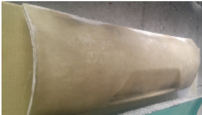
Gráfico 16: Aplicación del contramolde Fuente: Realizada por el Autor
