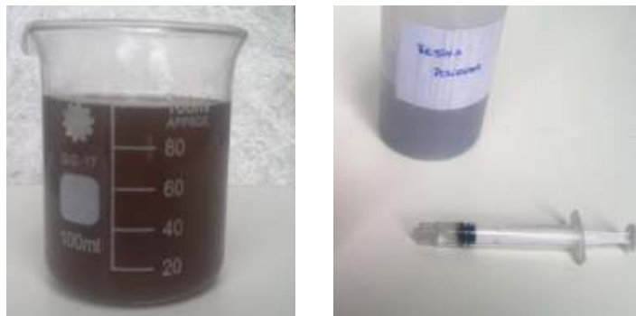
Figura 50: Obtención del cuerpo solido de Resina Poliéster (80 ml de RP y 0,8 gr de Catalizador MEK) (Fuente: Realizada por el Autor)
