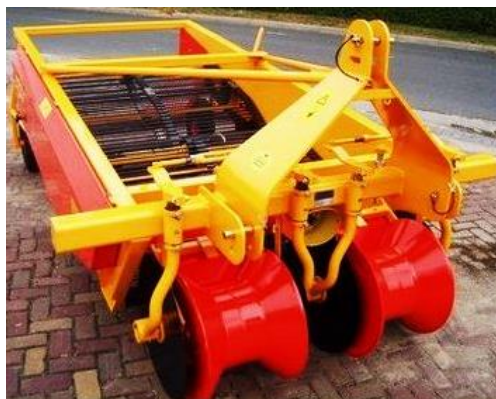
Figura 3-4: Cosechadora de papas doble surco Dooro [12]
