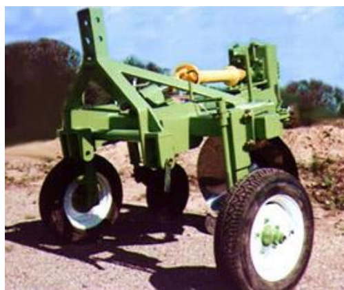
Figura 3-5: Cosechadora de papas tipo disco [13]
