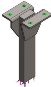
Figura 3-18: Análisis estático cargas y sujeciones del brazo porta disco
