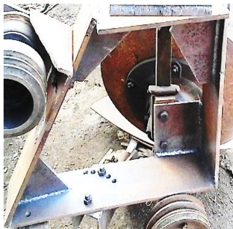
Figura 3-65: Brazo soporte y vertedera
