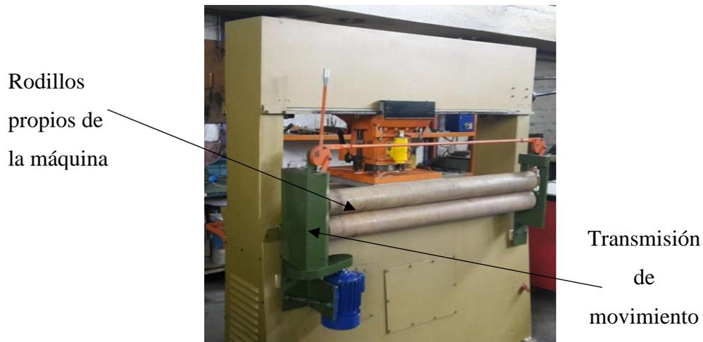
Figura 3-36. Máquina troqueladora de puente ATOM G 888.
