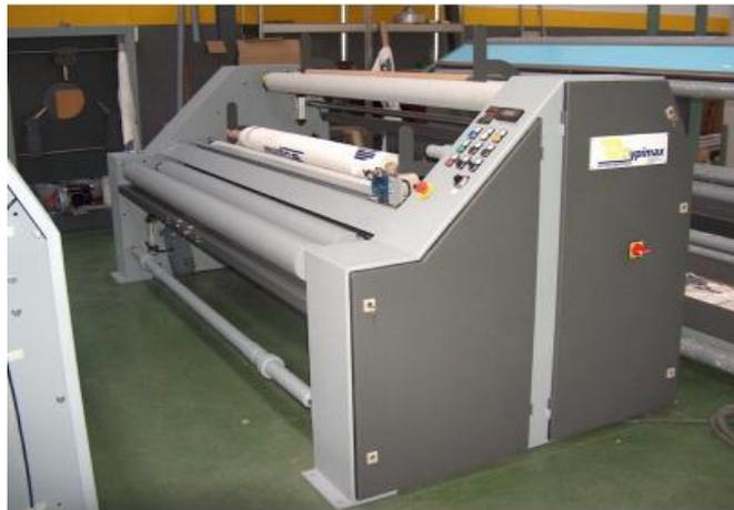
Figura 2-18. Eced 180 máquina enrolladora.
