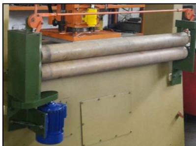
Figura 3-61. Rodillos troqueladora ATOM G888.
