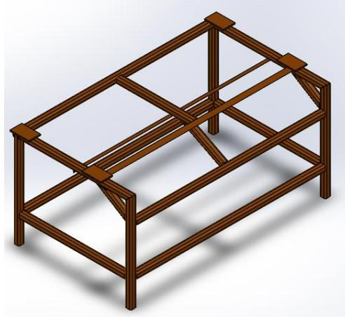
Figura 3-39. Estructura del dispensador de tela.
