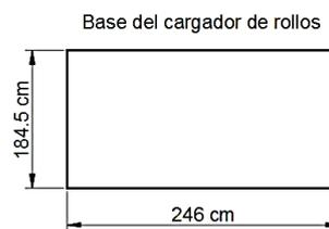
Figura 3-7. Dimensiones de la base del cargador.
