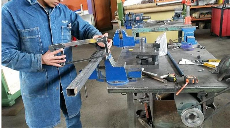
**Corte de los tubos para los rodillos de transporte de material**
