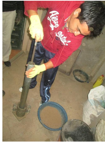
Compactación del suelo en capas
