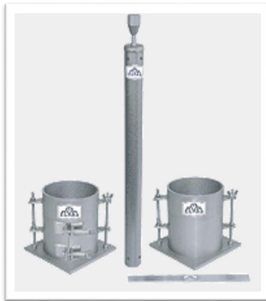
Ilustración 16: Equipo Próctor Modificado
