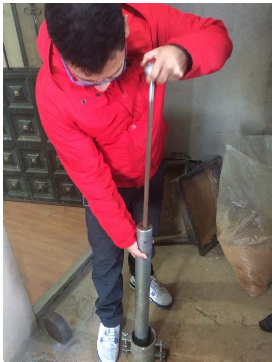
Ensayo de compactación
