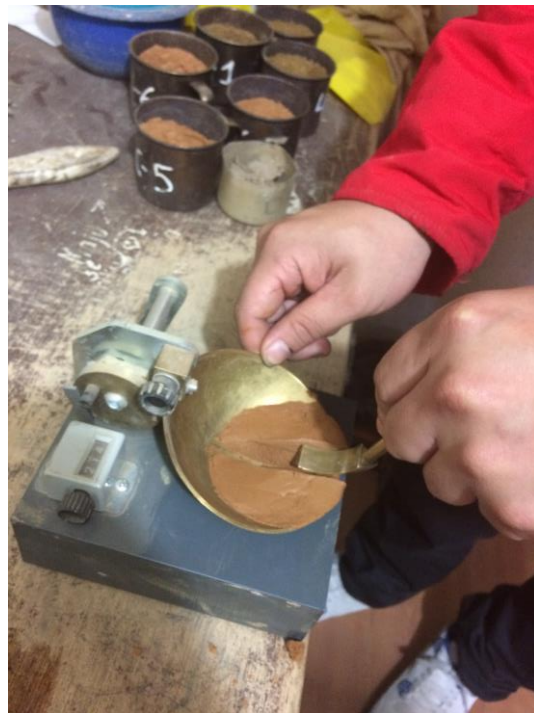
Ensayo de Límites de Atterberg
