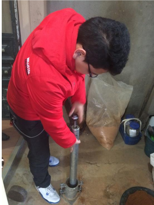
Ensayo de compactación
