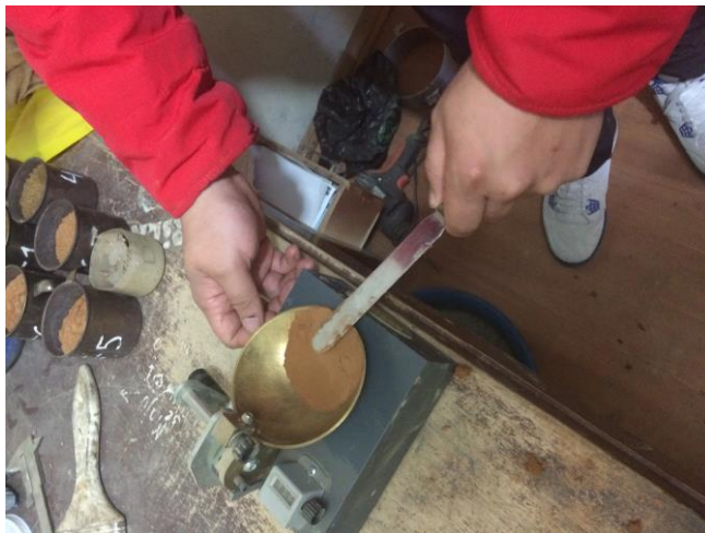
Ensayo de Límites de Atterberg
