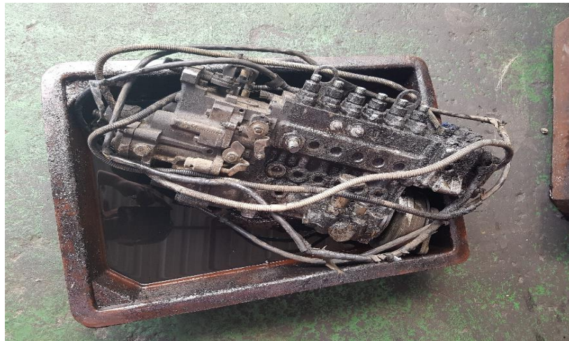
Ilustración 3-1 Bomba de inyección IZUZU FTR. Fuente: Jonathan Abril, Investigador
