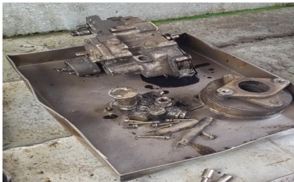
Ilustración 3-2 Bomba de inyección desarmada. Fuente: Jonathan Abril, Investigador
