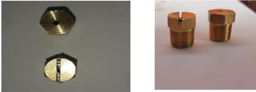
Ilustración 1-12 Diseño de aspersores. Fuente: Jonathan Abril investigador
