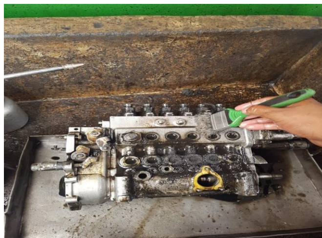
Ilustración 3-4 Lavado de bomba de inyección. Fuente: Jonathan Abril, Investigador
