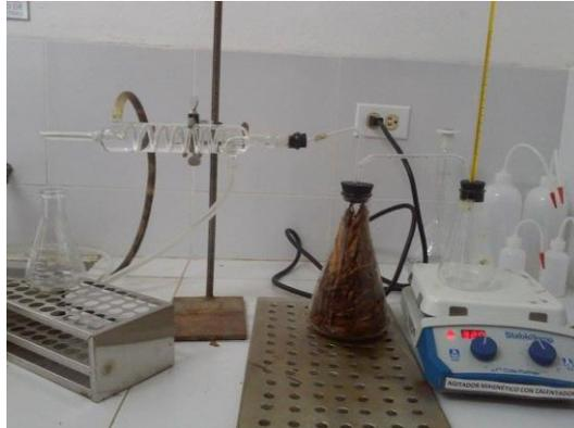
**Anexo 1. Obtención del aceite de canela por el método de destilación por arrastre de vapor.**
