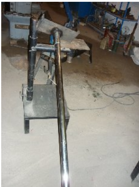
Figura 6.28: Base con pedestal terminada, para montaje del equipo Elaborado por: Investigador
