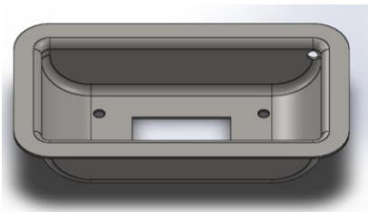
Figura 3. 1 Forma de la chapa de compuerta embutida 1
