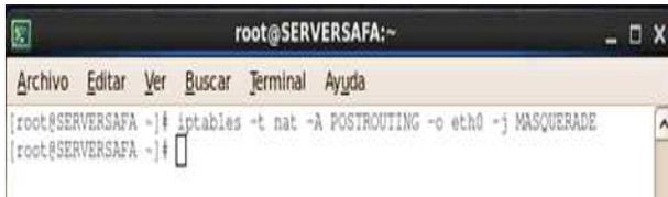
**FIGURA 6.9 CONFIGURACIÓN FIREWALL PARA ENRUTAMIENTO IP**
