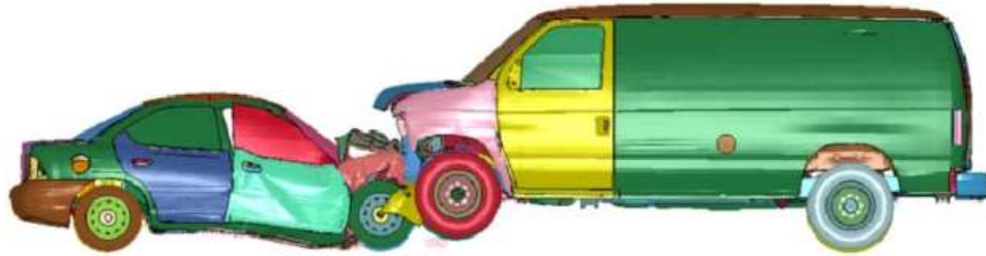
Figura 7. Simulación de un impacto frontal entre 2 vehículos. (Fuente: (Moradi R, 2013))
