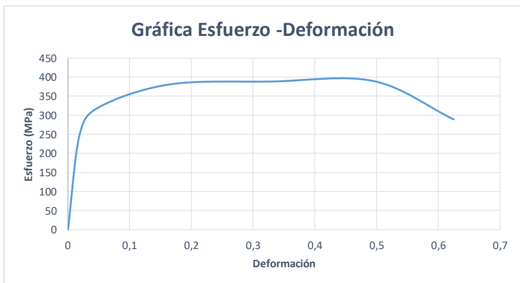
Figura 32. Gráfica de Esfuerzo – Deformación del material utilizado en la simulación. (Fuente: Autor)
