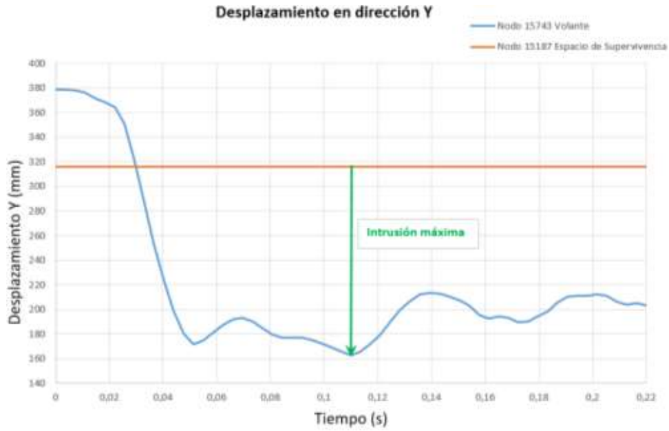
Figura 35. Desplazamiento del volante respecto al espacio de supervivencia en la dirección Y. (Fuente: Autor)
