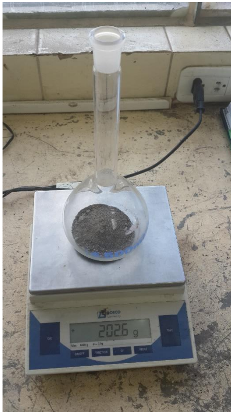
Peso del picnómetro más agregado fino – Densidades del agregado fino
