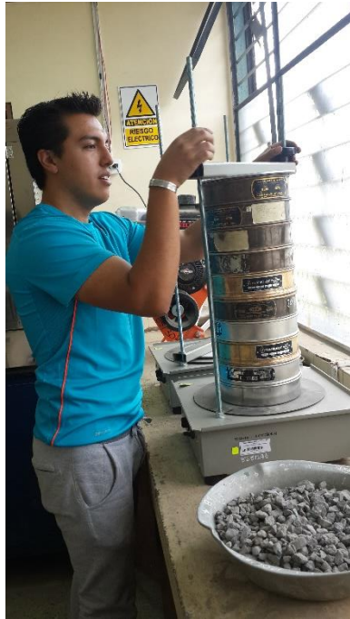
Granulometría del agregado - Tamizado
