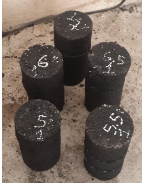
Figura 31: Briquetas de Asfalto
