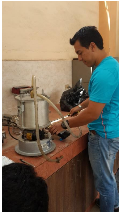
Preparación de la máquina de vacíos – Ensayo RICE
