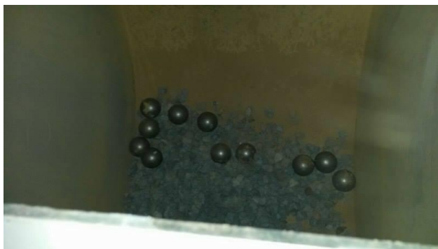
Figura 8: Máquina de los Ángeles + muestra + 11 esferas
