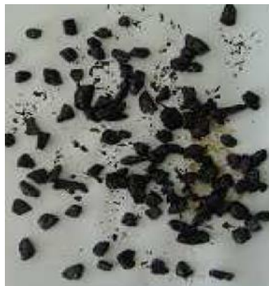
Figura 16: Estimación del porcentaje de asfalto que cubre al agregado.
