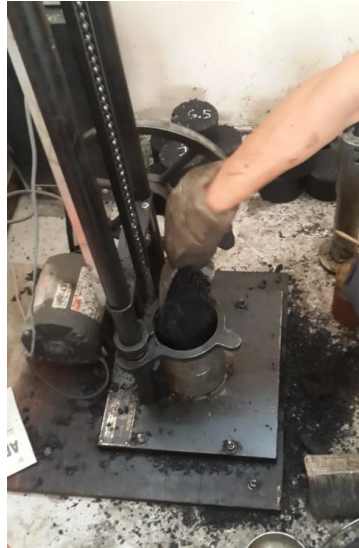
Figura 22: Colocación de la mezcla asfáltica en la máquina compactadora
