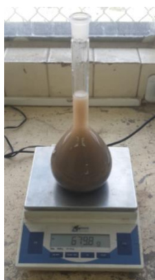
Figura 9: Masa del picnómetro + muestra + agua
