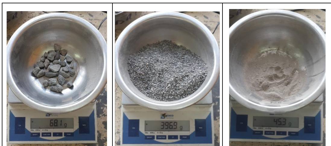
Figura 19: Proporciones de agregados para la elaboración de la mezcla asfáltica.
