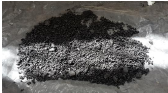
Figura 15: Mezcla Asfáltica fría.
