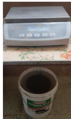
Figura 13: Masa de la canastilla + muestra SSS en el agua
