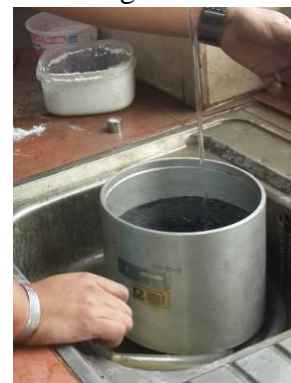
Figura 18: Recipiente + Agregado + Agua
