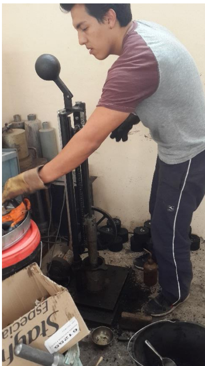
Preparación del martillo para la compactación
