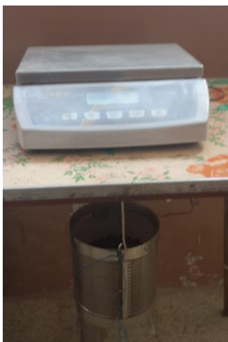
Figura 12: Masa de la canastilla + muestra SSS
