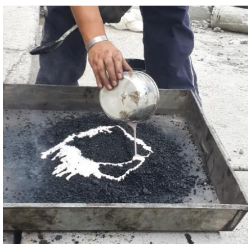
Figura 28: Mezcla Asfáltica + Látex.
