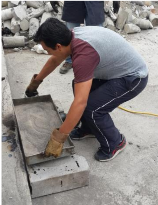
Agregado Fino Calentado – 180 °C
