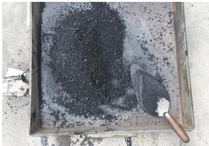
Figura 21: Muestra preparada para la compactación
