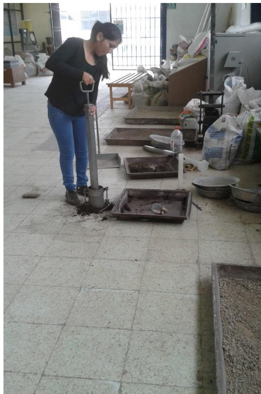
Ensayo de Compactación
