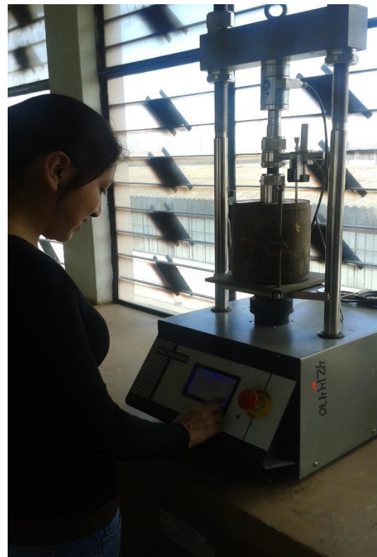
Ensayo de CBR
