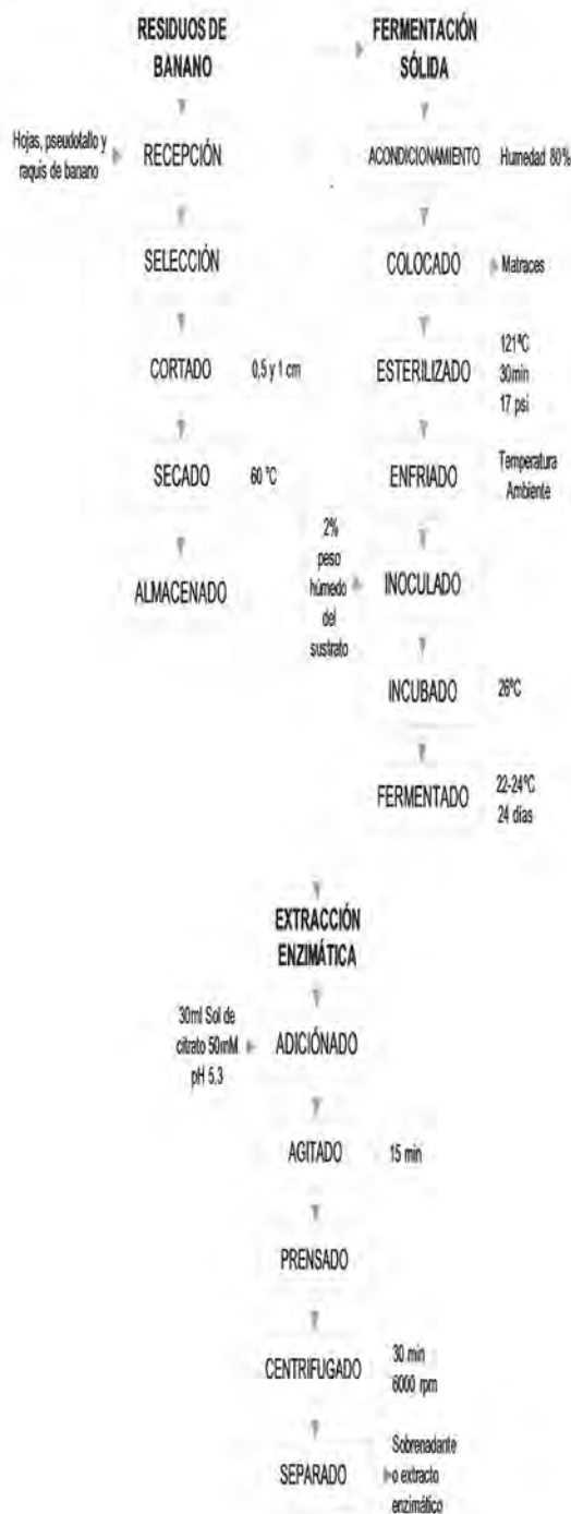
Figura 1. Diagrama de flujo para la obtención de enzimas celulasas por fermentación sólida de hongos ( Pleurotus ostreatus , Pleurotus pulmonarius y Lentinula edodes ), utilizando como sustratos los residuos del cultivo del banano ( Musa cavendish )
