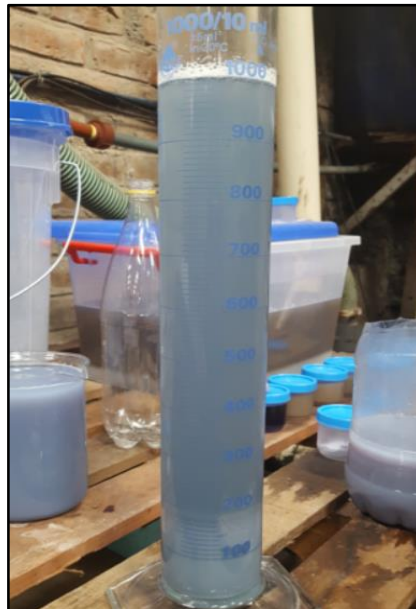
Fig. 35: Efluente después de 12 horas de precipitación con un punto de partida de pH 9.
