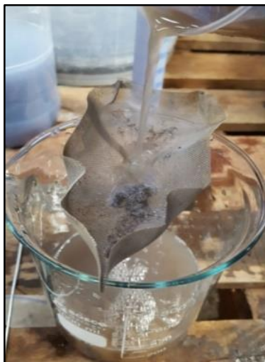
Fig. 36: Efluente homogenizado filtrado en la malla de 200 micras.
