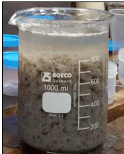
Fig. 38: Formación de flóculos en el efluente.
