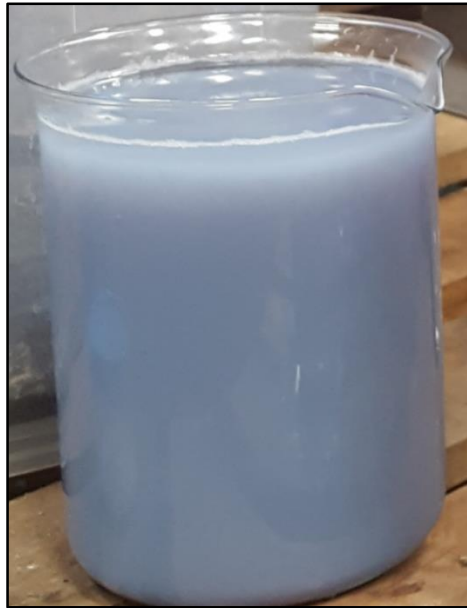
Fig. 33: Reacción del efluente al subir su pH a 10.
