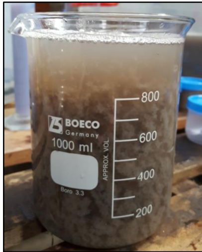
Fig. 37: Formación de coágulos en el efluente.
