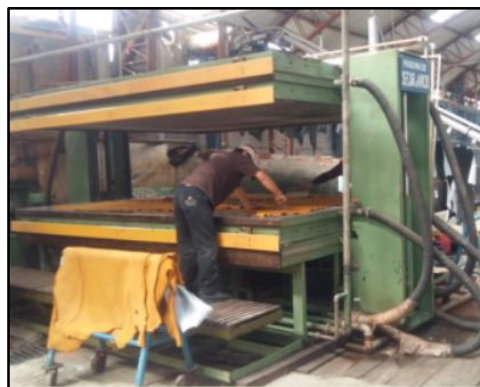
Fig. 13: Operación de secado al vacío.
