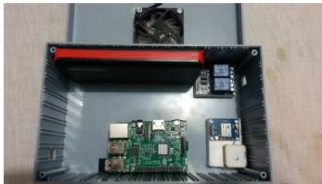
Fig. 4.18 Ubicación de placas en el interior del armazón Elaborado por: Investigador
