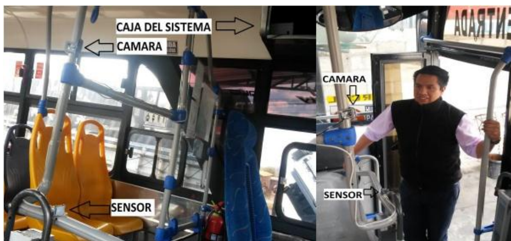
Fig. 4.20 Conexión del sistema de reconocimiento en una unidad de transporte
