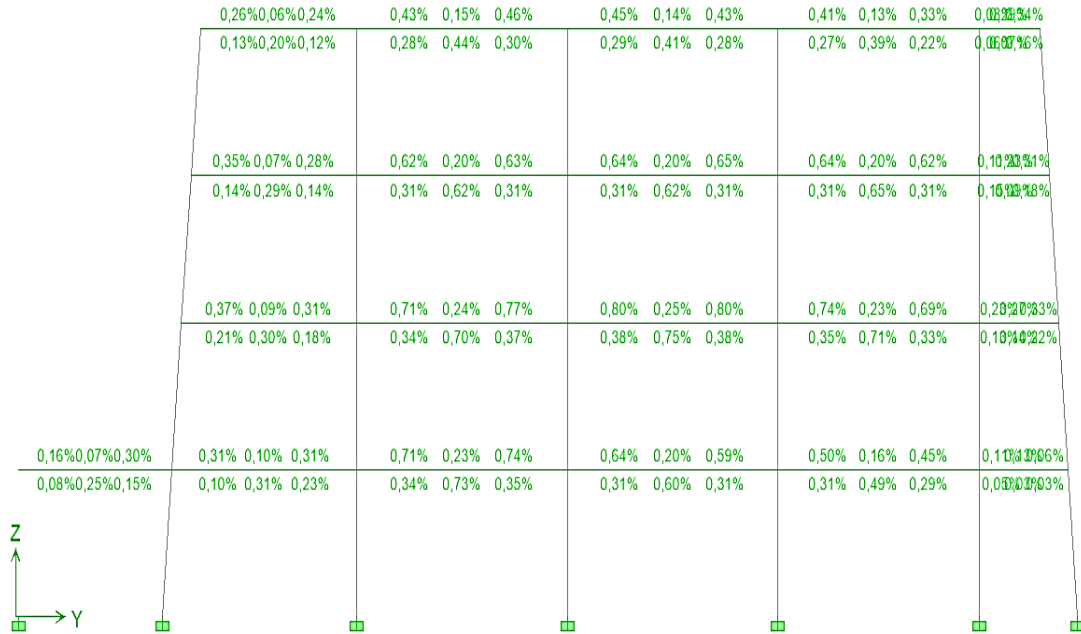
Figura 33: Cuantía en vigas, Método Por Fuerzas
