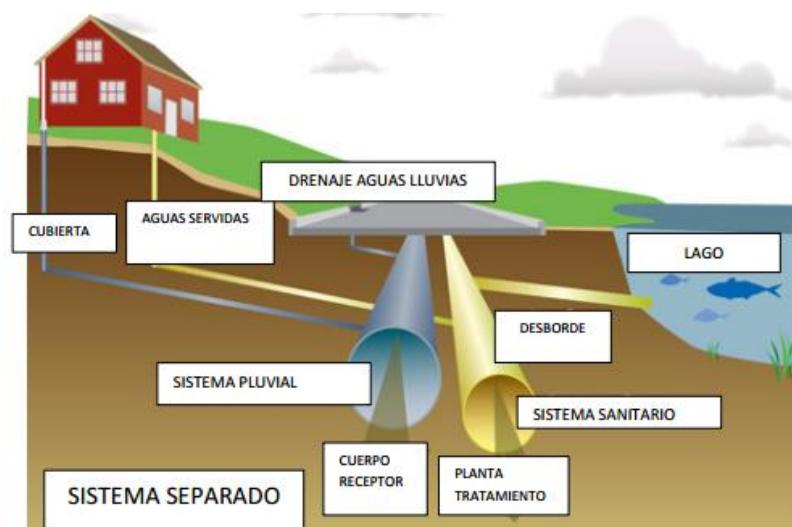
IMAGEN II- 3: Esquema de un sistema de alcantarillado separado
