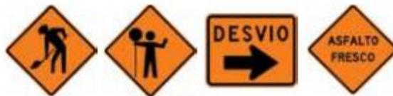
Gráfico 4: Señales para trabajos en la vía y propósitos especiales
