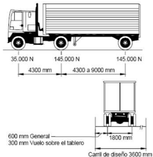
Gráfico 16.- Características del camión de diseño
