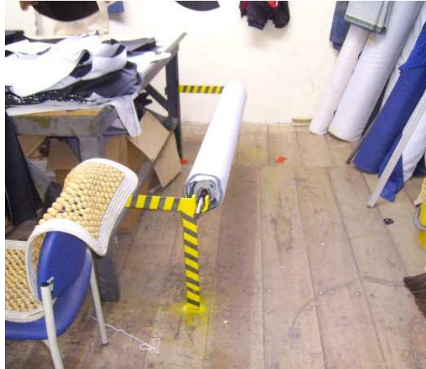
SEÑAL DE RIESGO DE BAJA ALTURA
