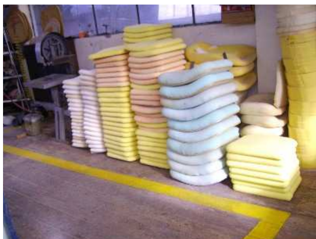
SEÑALIZACION DEL AREA DE APILAMIENTO
